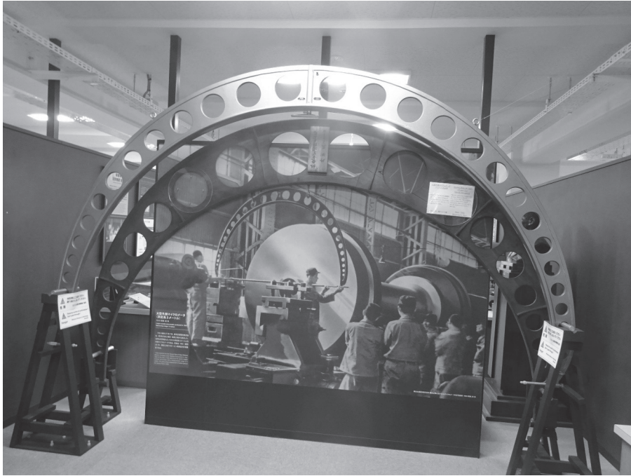
1952年当時世界最大の3m外側マイクロメーター。測定範囲：2,800mm～3,000mm 目量：0.01mm (筆者撮影)
